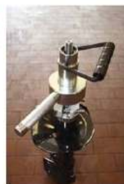
Aparafuse a ferramenta básica extensível no alojamento do mancal intermédio
