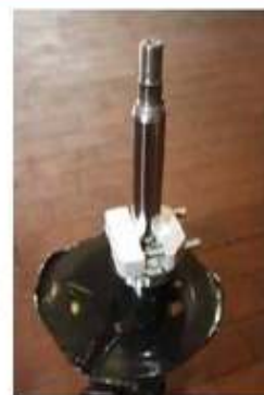
Equipe o mordente de aperto com parafusos de aperto (em função do Ø do êmbolo)
