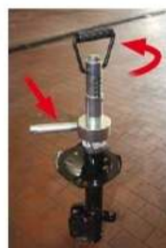
No final, fixe a posição do êmbolo apertando a peça de aperto
