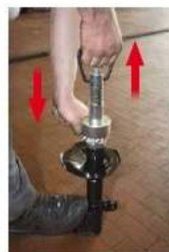
Extraia vigorosamente o tubo extensível manualmente e bloqueie-o através de uma ligeira rotação à esquerda/direita Para molas de batente de tracção, cuja resistência não possa ser ultrapassada com a força de tracção normal, existe a possibilidade de extrair o êmbolo mais 20 mm aprox., exercendo uma contrapressão no mancal intermédio e simultaneamente realizando uma rotação da ferramenta básica extensível
