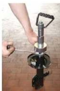
Tubo expansível: Fecho rápido (11 posições) Mancal axial Punho de tracção e rotativo Bucha em plástico Fecho da extensão
