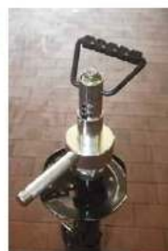
Fixe o êmbolo com a porca de fixação original
