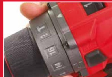
Embragem electrónica com 13 posições de torque, 1 para furação e 1 para furação com percussão
