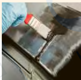
Aplicação da camada protetora anticorrosiva do Teroson EP 5055
