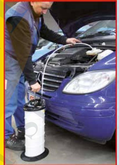
160.0865 Bomba de aspiração a vácuo com depósito para 6,5 litros
