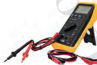
**Multímetro incluindo pontas de teste, terminais de crocodilo, pinça de indução e sonda de temperatura**
