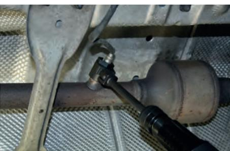
**Kit de pontas de chave de caixa para sondas Lambda/ comutadores térmicos/ injetores**
