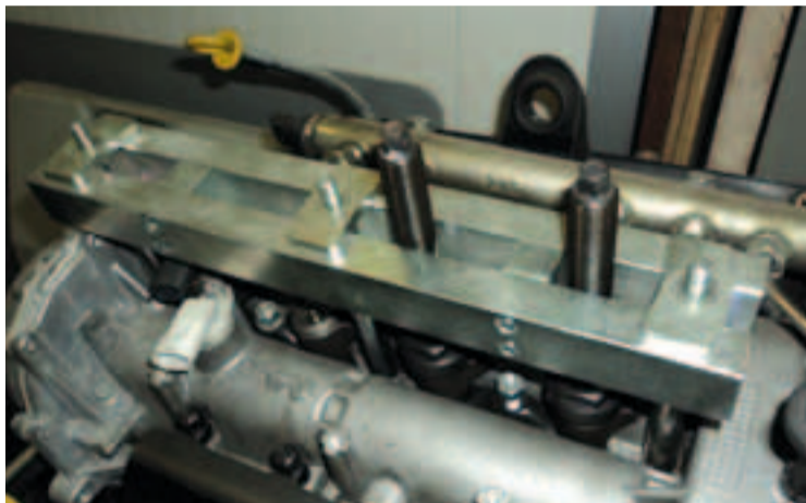
Extractor para quitar los inyectores instalados en motores 1.3 Multijet
