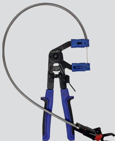
O alicate de encaixe rápido flexível com luva foi projetado para abrir conectores rápidos com travamento duplo (isto é, ARaymond) sem danificá-los.
