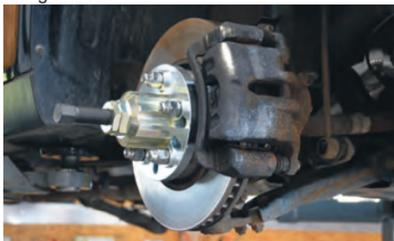
Empurrando o eixo de acionamento, mecanicamente, usando o conjunto de ferramentas
