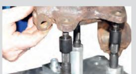
Kit adicional para suporte de impressora 050, composto por 4 pinos de centralização diferentes, que garantem um posicionamento rápido e seguro no componente em que o usuário trabalha. O kit incluía uma tira magnética na qual as ferramentas podem ser armazenadas.
