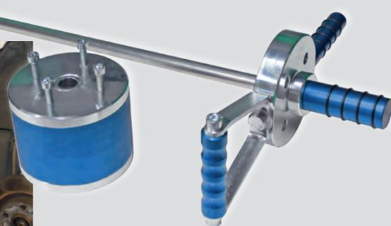
Para uma poderosa expulsão de componentes presos, bem como para trabalhos de alisamento corporal. A nova versão do martelo deslizante é preenchida com esferas de aço, impedindo qualquer recuperação. Assim, a intensidade do impacto é aumentada porque a força de impacto total é transmitida ao componente no qual está a trabalhar.
