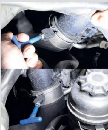
Ferramenta especial para libertar/soltar Henn® abraçadeiras, usadas no setor automotivo nos tubos de água do sistema de refrigeração e nos radiadores
