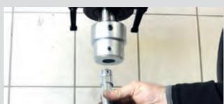
Kit adicional de punções para prensas de oficina, com capacidade até 25 T, com diferentes diâmetros da haste Ø40 | Ø40 Ø50. 6 socos diferentes estão incluídos. Suporte de peça incluído.
